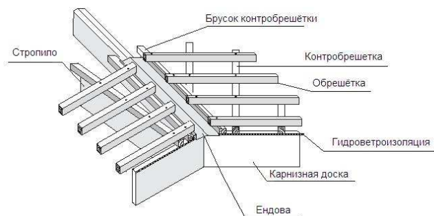
Вариант монтажа ендовы с контробрешёткой
